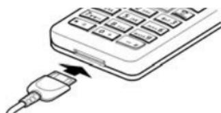
При поставке аккумулятор заряжен не полностью. Вставьте штекер зарядного устройства в гнездо в нижней части телефона, подключите зарядное устройство к сети питания и заряжайте аккумулятор не менее двух часов.
