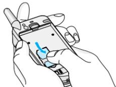
Гнездо для установки SIM-карты находится на задней панели телефона. Следуйте следующим указаниям по установке SIM-карты.
