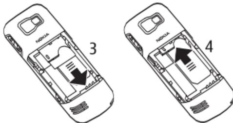
6. Следуйте указаниям третьего и четвертого этапов раздела "Установка SIM-карты и аккумулятора" для того, чтобы установить аккумулятор и заднюю крышку на место.
