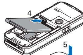
Прикладіть верхню частину задньої панелі до верхньої частини телефону (5) і натисніть на нижню частину задньої панелі, щоб закріпити її (6).
