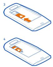
4 Выровняйте контакты аккумулятора, вставьте аккумулятор (5), затем верните на место заднюю панель (6).
