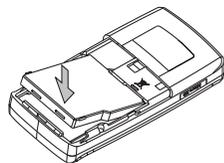
6. Установите заднюю крышку на место, вдвинув ее в пазы до упора.
