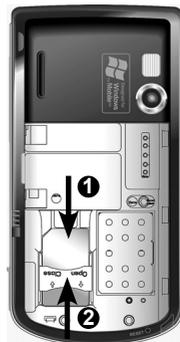
3. Поместите выступающие контакты батареи в соответствующие отверстия на дне отсека и нажмите на батарею до щелчка, означающего, что батарея зафиксирована.
