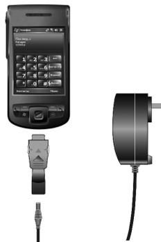
Индикатор питания загорится, когда устройство обнаружит внешний источник питания, поступающего от зарядного устройства или по USB. Для проверки состояния заряда батареи, пожалуйста, обратитесь к настройкам питания коммуникатора.
