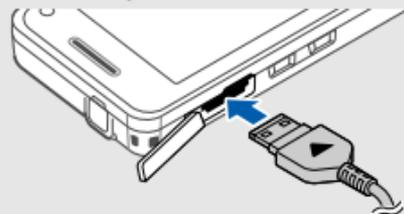
Треугольник должен быть направлен на переднюю часть телефона
