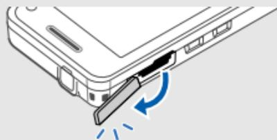
2. Вставьте узкий конец провода зарядного устройства в разъем.
