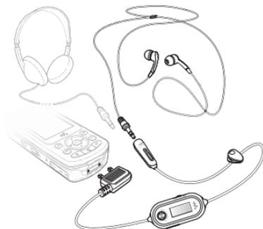
Гарнитура HPM-80 предназначена для прослушивания радиопередач и управления проигрывателем WALKMAN™ в телефоне. Если при подключенной гарнитуре HPM-80 поступает входящий вызов, воспроизведение музыки останавливается и возобновляется после завершения (или отклонения) вызова. Гарнитуру HPM-80 можно использовать как стандартную минигарнитуру для приема и отправки вызовов (также и тогда, когда она выключена).
