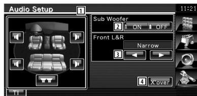
1 Выбор акустических систем для настройки разделительного фильтра. См. <Настройка разделительного фильтра> (стр. 57).
