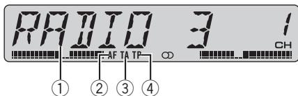
Das Radio-Daten-System (RDS) dient der Übertragung spezieller Informationen in Verbindung mit den UKW-Programmen. Durch diese nicht hörbaren Informationen stehen Funktionen wie Programm-Service-Name, Programmtyp, Verkehrsdurchsagebereitschaft und automatische Abstimmung bereit, die es dem Hörer ermöglichen, die gewünschten Sender schneller aufzufinden und abzustimmen.
