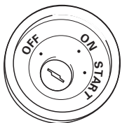
Assenza di posizione ACC
