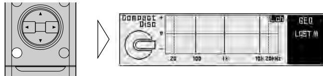
После заглавного экрана дисплей переходит к рабочему экрану меню эквалайзера (equalizer menu). При открытой или закрытой крышке пульта дистанционного управления (см. с. 5) дисплей меню и экран настроек переходит соответственно в открытое или закрытое состояние.
