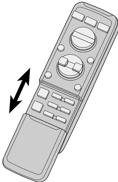
В этой системе меню отображается при открытой и при закрытой крышке, но доступные функции меню различны в зависимости от состояния используемого пульта дистанционного управления.
