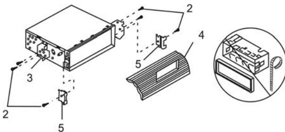
Закрепите кронштейны с обеих сторон DVD-ресивера не менее чем в двух местах. Для этого используйте либо крепежные винты (5 x 8 мм), либо винты с потайной головкой (4 x 8 мм), в зависимости от типа резьбовых отверстий на кронштейне.
