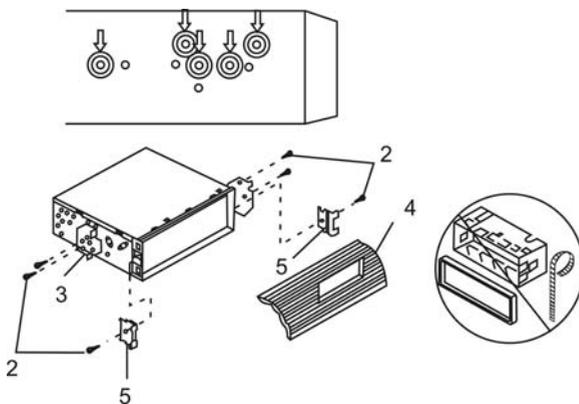
1. Выберите положение кронштейнов, при котором будут совмещены резьбовые отверстия на кронштейнах и резьбовые соединения на корпусе CD-ресивера. Закрепите кронштейны с обеих сторон CD-ресивера не менее чем в двух местах. Для этого используйте либо крепежные винты (5 x 8 мм), либо винты с потайной головкой (4 x 8 мм), в зависимости от типа резьбовых отверстий на кронштейне.
