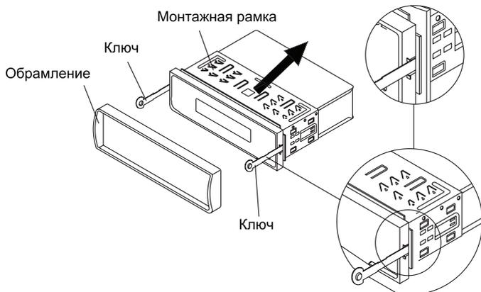
4. Вставьте монтажную раму (без ресивера) в отсек приборной панели и отогните «язычки» при помощи отвертки. Не все «язычки» подходят под размер приборной панели автомобиля, выберите наиболее подходящие.
