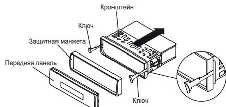
6. Вставьте манжету в отверстие приборной панели и отогните расположенные вокруг нее зажимы с помощью отвертки. Не все зажимы будут обеспечивать контакт, поэтому найдите среди них наиболее подходящие для этого. Чтобы закрепить манжету на месте, отогните соответствующие зажимы таким образом, чтобы они касались приборной панели.
