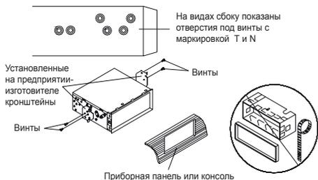
Закрепите аппарат в установленных на предприятии-изготовителе кронштейнах. Совместите отверстия под винты на кронштейне и на аппарате. Установите винты (5x5 мм) с обеих сторон.
