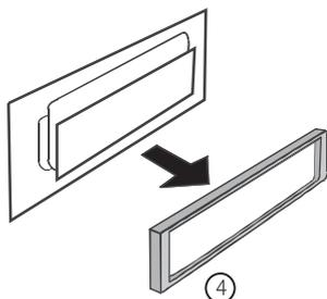
2. Вставьте ключи, входящие в комплект устройства, по бокам устройства так, как показано на рисунке, до щелчка. Потянув за ключи, извлеките устройство из приборной панели.
