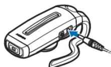
Время работы от полностью заряженного аккумулятора достигает 5,5 часов в режиме разговора и 150 часов в режиме ожидания. Однако продолжительность работы в режиме разговора и в режиме ожидания зависит от моделей используемых мобильных телефонов, устройств Bluetooth, используемых параметров и стилей, а также от условий эксплуатации.
