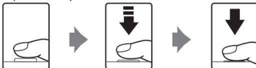
Для фокусировки и установки экспозиции нажмите спусковую кнопку затвора наполовину.
