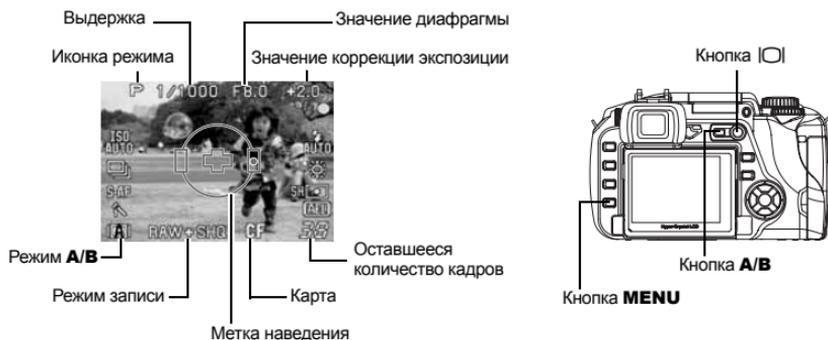
Имеются два режима реального изображения – режим А и режим В (фиксация ручного фокуса). Возможно переключение режимов в зависимости от условий съемки.
