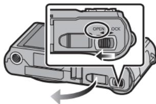
**2** Аккумулятор: вставляйте до блокировки рычажком (A), внимательно следя за направлением при вставке. Потяните рычажок (A) в направлении стрелки, чтобы извлечь аккумулятор.
