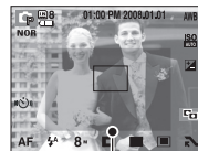
[Диапазон обнаружения движения для таймера движения]
