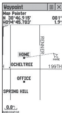
Перемещение путевой точки
