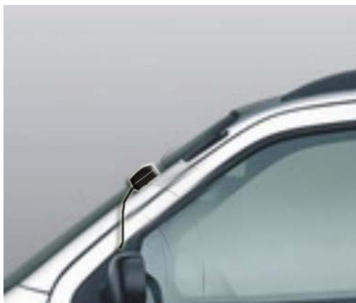
**Внимание:** если Вам необходимо обеспечить точность позиционирования и точность измерения скорости, то мы рекомендуем использовать внешнюю антенну.
