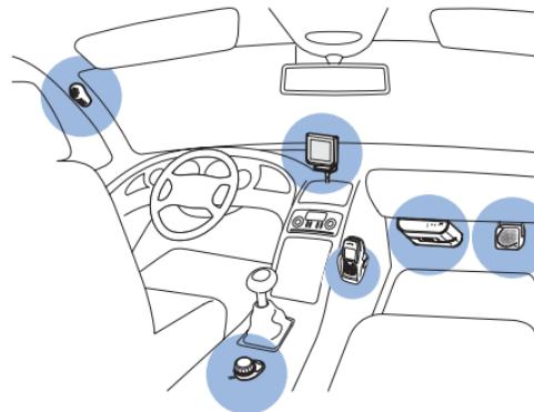
*Приклад належного встановлення дисплея, закріпленого за допомогою клейкої пластиини, яка входить до комплекту постачання*
