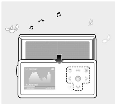
**Під час прослуховування музики або радіо перемістіть передню частину плеєра в напрямку, позначеному стрілкою**
