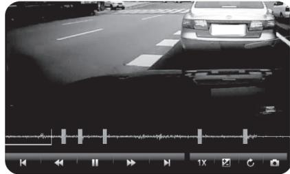
График в нижней части окна проигрывателя отображает степень воздействия по оси X (спереди и сзади), по оси Y (слева и справа) и по оси Z (сверху и снизу) во время происшествия.
