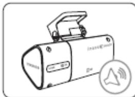
Через 10 секунд после того, как загорится индикатор питания, прибор подаст звуковой сигнал 3-й громкости и начнет запись. Видео регистратор будет осуществлять непрерывную запись видео и звука и сохранять файлы на установленную в него карту памяти.
