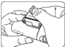
Снимите защитную ленту с клейкой наклейки крепления и приложите его к месту установки на ветровом стекле так, чтобы объектив видео регистратора был направлен вперед.
